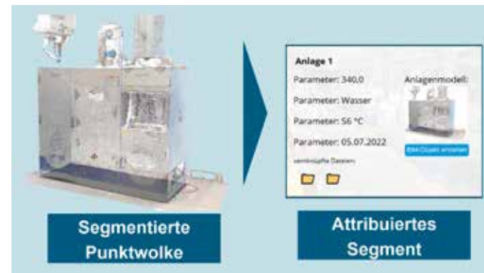
Abbildung: Zielbild eines Bestandsdatenviewers zur Nutzbarmachung von Punktwolken.
